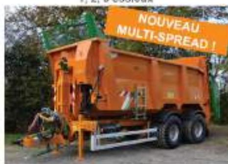
Épandeur sur porte-caisson (table d'épandage ou vis verticales)
